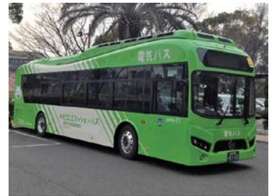
用し軽量化を図っています。さらにこれまでの電池では充電1回あたりの走行可能距離が20km～30kmだったものが、今回は三菱重工の高性能リチウムイオン電池を採用し、充電1回あたりの走行可能距離が80kmと大幅に延びたそうです。
